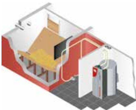
Aspiración con transportador con tornillo sinfín para descarga de pellets
